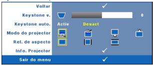
**KEYSTONE V.**—Esta opção ajusta a distorção da imagem provocada pela inclinação do projector.
